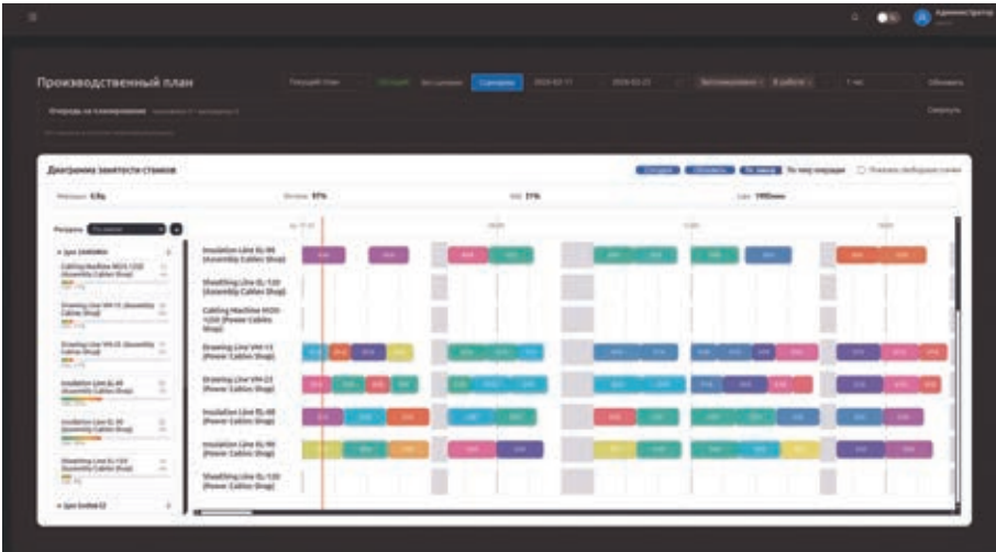
Рис. 5. Производственный план и диаграмма загрузки оборудования в системе ЦЕХ
