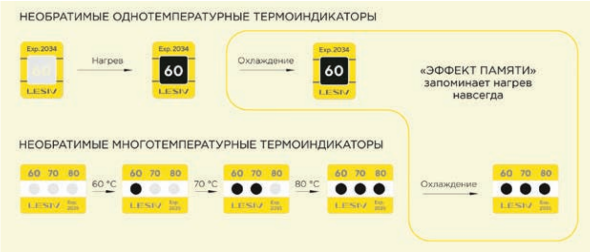
Рис. 3. Внешний вид и принцип работы термоиндикаторов
