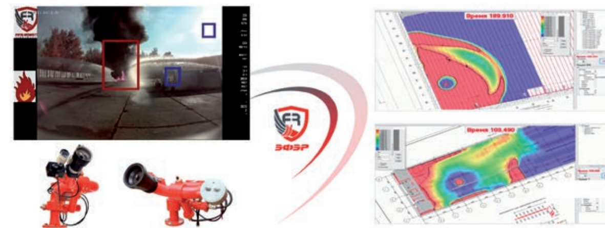
Рис. 3. Автоматический поиск и обнаружение очага возгорания в 3D системе координат
