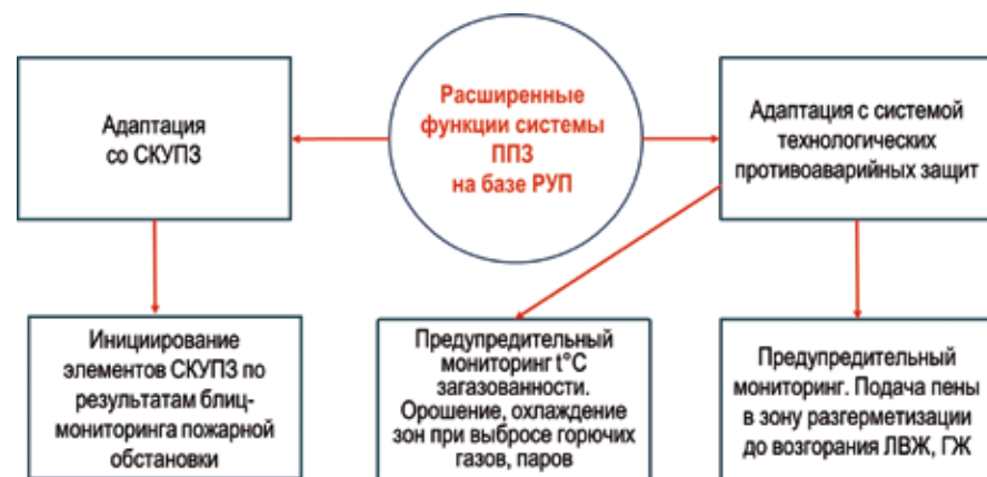
Рис. 5. Адаптация Комплекса ППЗ с системами противоаварийных защит и комплексного управления противопожарной защитой
