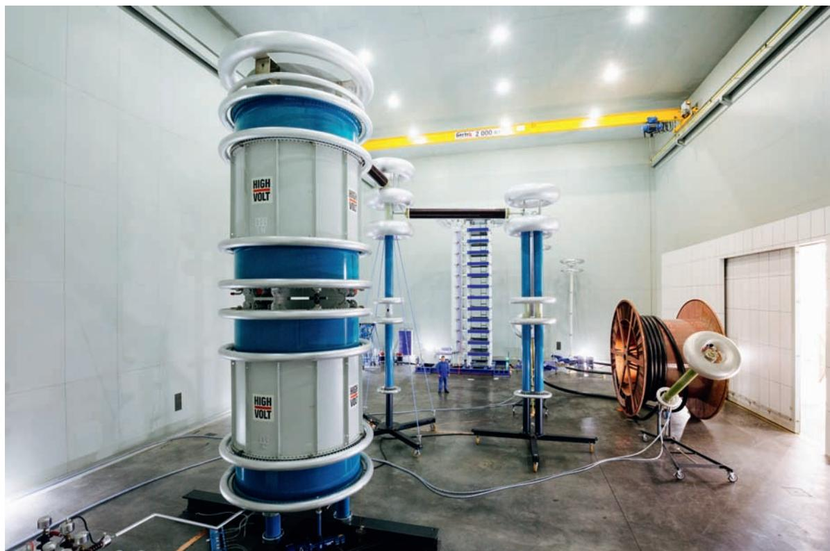
В состав ООО «Завод ТАТКАБЕЛЬ» входит аккредитованный испытательный центр. ИЦ оказывает полный комплекс квалификационных, типовых, периодических и приемосдаточных испытаний. В ходе приемосдаточных испытаний осуществляется 100% контроль каждой строительной длины кабеля, выпускаемого заводом.
