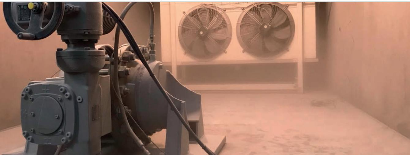
Продукция прошла полный цикл испытаний на подтверждение расходных, кавитационных, ресурсных характеристик, а также климатические испытания на работоспособность и герметичность седла (при температуре до минус 60°C), криогенные испытания (при температуре до минус 196°C), испытания на сейсмостойкость, устойчивость к сероводородному растрескиванию и испытания на соответствие требованиям стандартов ГОСТ, ПАО «ГАЗПРОМ», ПАО «ТРАНСНЕФТЬ».
