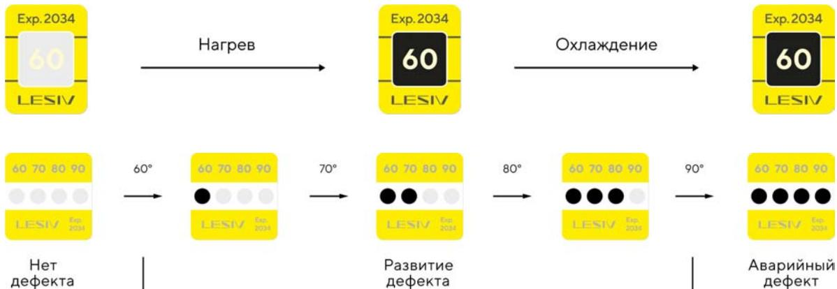
Рис. 1. Внешний вид и принцип работы термоиндикаторов
