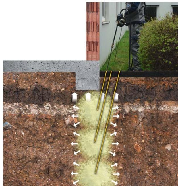
Рис. 2. Технология укрепления грунтов полимерными смолами
