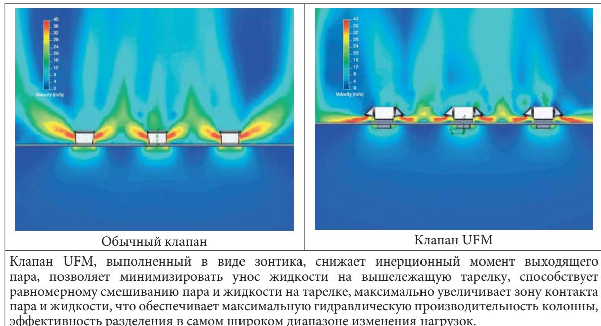
Клапан UFM, выполненный в виде зонтика, снижает инерционный момент выходящего пара, позволяет минимизировать унос жидкости на вышележащую тарелку, способствует равномерному смешиванию пара и жидкости на тарелке, максимально увеличивает зону контакта пара и жидкости, что обеспечивает максимальную гидравлическую производительность колонны, эффективность разделения в самом широком диапазоне изменения нагрузок.
