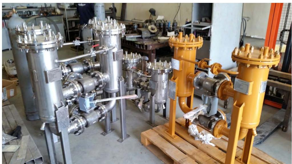
Низкая поверхностная энергия фторопласта-4 при фильтрации через него суспензий или аэрозолей полярных и неполярных веществ приводит к тому, что первые смачиваются, а вторые отталкиваются от поверхности ФФЭ. Обладают исключительно высокой сепарирующей способностью при отделении воды от углеводородов, т.к. практически не смачиваются водой.
