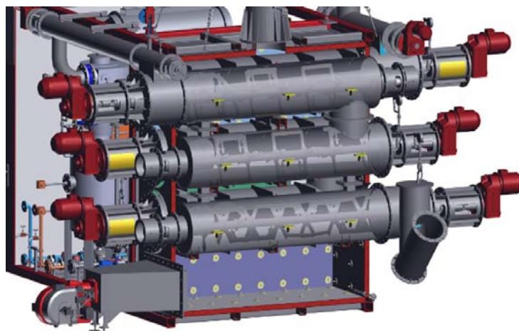
*Десорбция происходит в изолированной от кислорода закрытой среде без избыточного давления, без налипания вещества на стенки, без образования на внутренней поверхности камеры «керамической корки», препятствующей передаче тепла.*
