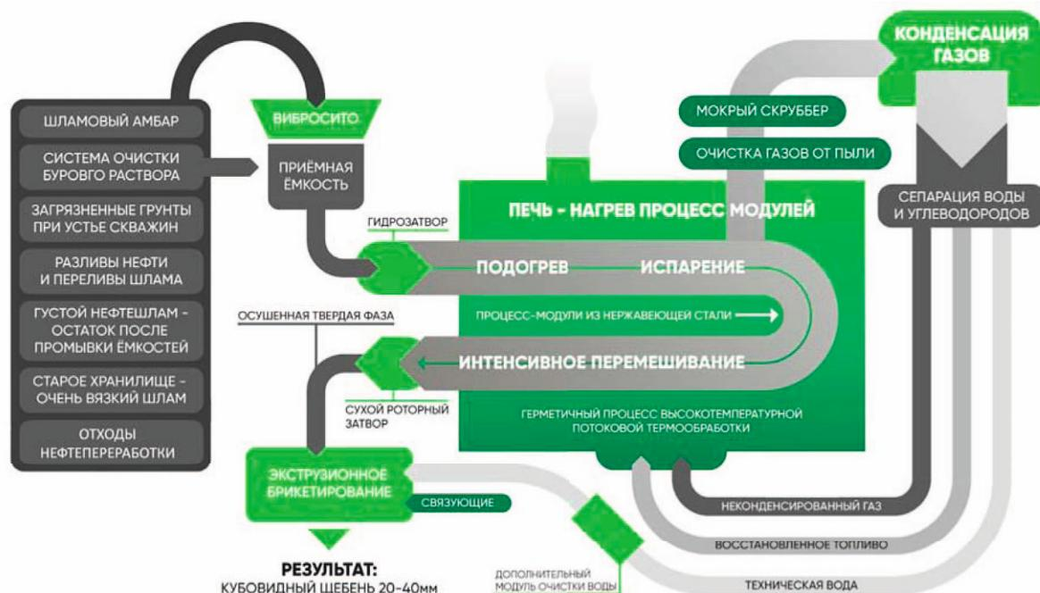
*Время нахождения материала внутри установки всего 7–10 минут! Это обеспечивает высокую производительность в минимальных габаритах.*
