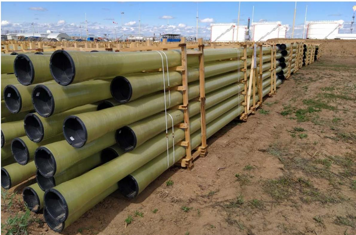
**Композитные трубы для нефтегазохимической отрасли**
