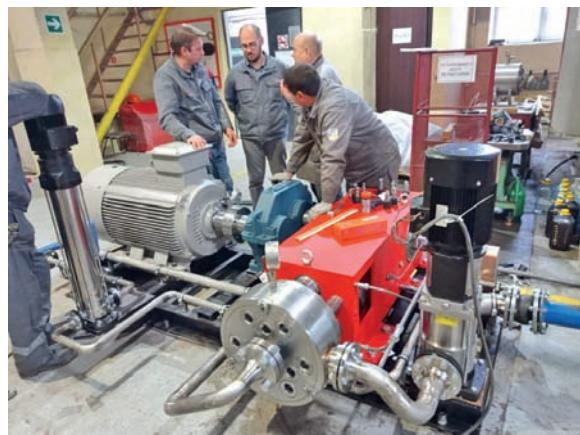
**Подготовка плунжерного насосного агрегата системы пожаротушения для АЭС «Руппур» с рабочим давлением 16 МПа к проведению приемочных испытаний**
