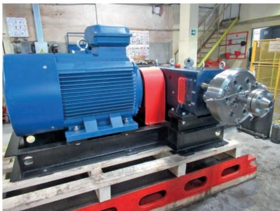
**Трехплунжерный насосный агрегат производства ООО «ГМТ»**
