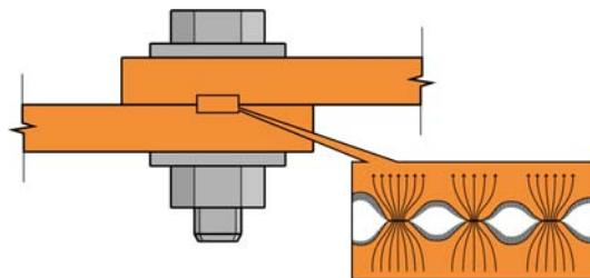
Рис. 5. Болтовое контактное соединение
