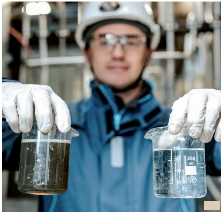
Результат переработки промышленных стоков методом многоступенчатой термодистилляции
