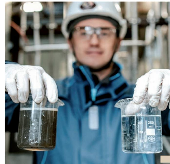
Результат переработки промышленных стоков методом многоступенчатой термодистилляции
