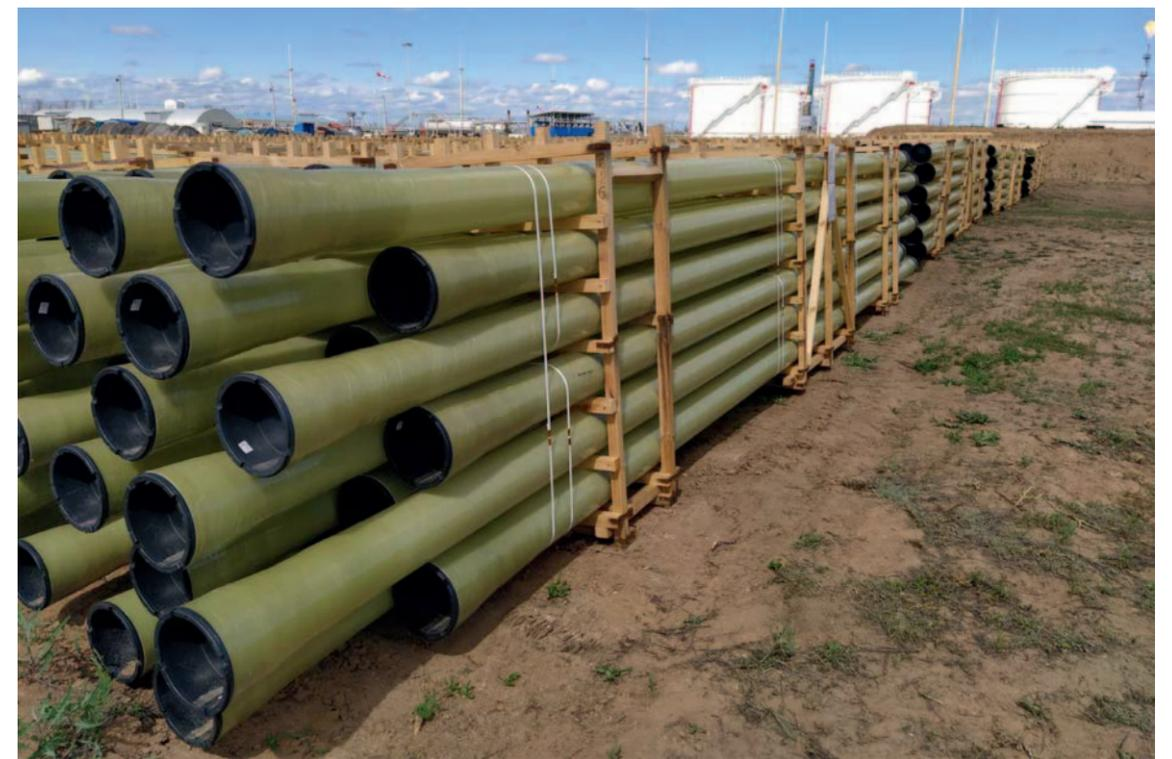
Композитные трубы для нефтегазохимической отрасли
