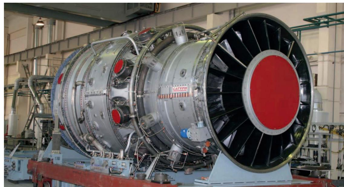
Газовая турбина ГТД-110М
