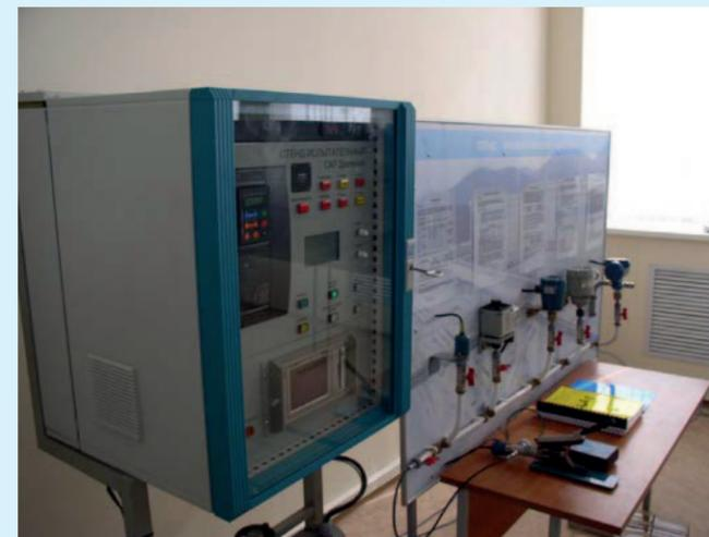
Стенд исследования систем автоматического регулирования
