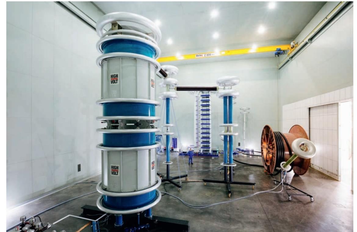
В состав ООО «Завод ТАТКАБЕЛЬ» входит аккредитованный испытательный центр. ИЦ оказывает полный комплекс квалификационных, типовых, периодических и приемосдаточных испытаний. В ходе приемосдаточных испытаний осуществляется 100% контроль каждой строительной длины кабеля, выпускаемого заводом.
