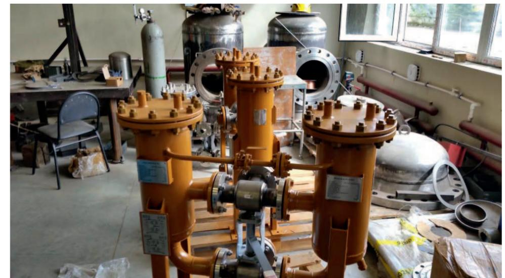
Низкая поверхностная энергия фторопласта-4 при фильтрации через него суспензий или аэрозолей полярных и неполярных веществ приводит к тому, что первые смачивают, а вторые отталкиваются от поверхности ФФЭ. Обладают исключительно высокой сепарирующей способностью при отделении воды от углеводородов, т.к. практически не смачиваются водой.
