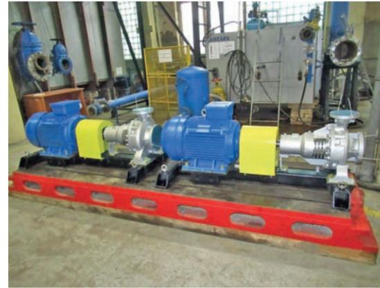
Насосные агрегаты ЦН 100/50 перед проведением приемо-сдаточных испытаний на испытательном стенде «Ангара»
