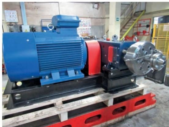
Трехплунжерный насосный агрегат производства ООО «ГМТ»
