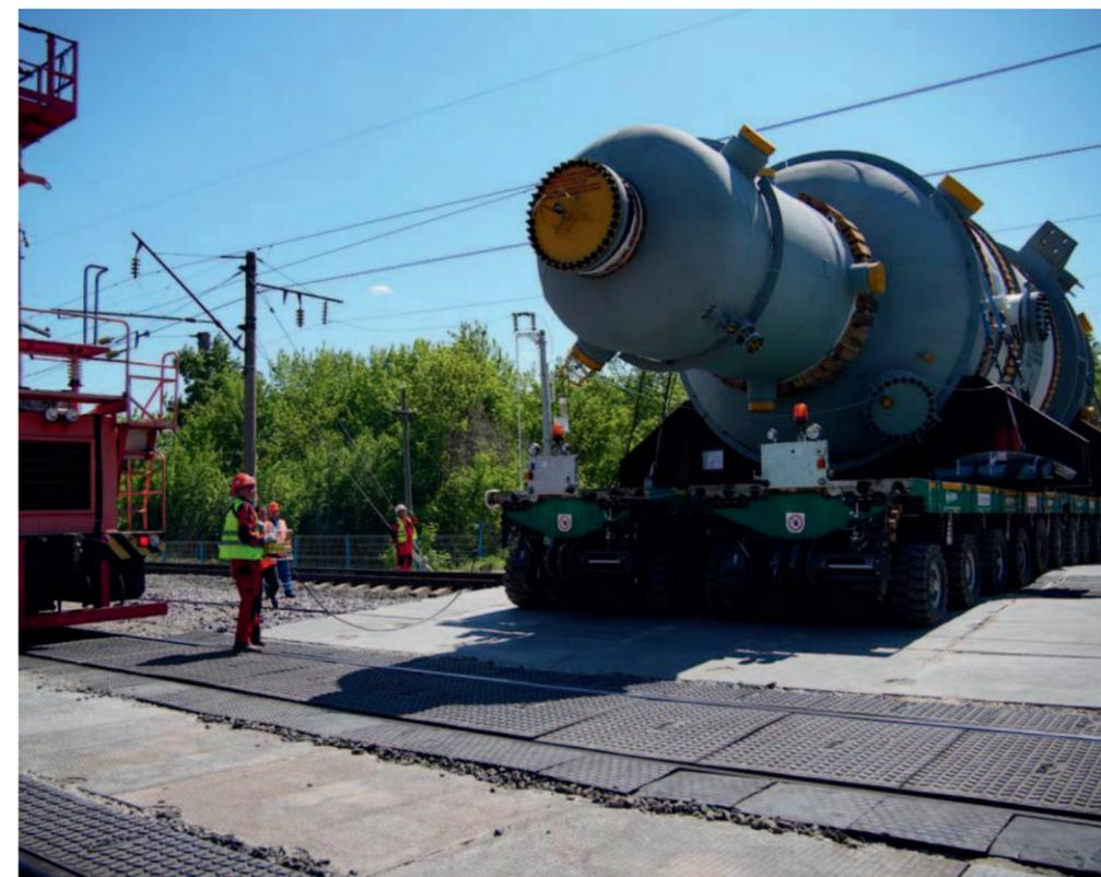
Кроме того, габарит высоты автопоезда с грузом не позволял проехать железнодорожный переезд без снятия напряжения в контактной сети.
