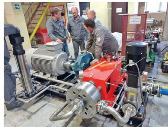
Подготовка плунжерного насосного агрегата системы жаротушения для АЭС «Руппур» с рабочим давлением 16 МПа к проведению приемочных испытаний
