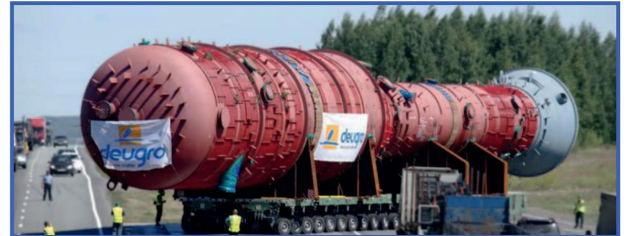
Специалистами нашей компании была разработана концепция транспортировки сверхнегабаритных и тяжеловесных грузов (длиной до 60-ти метров, диаметром свыше 7-ми метров и массой до 500 тонн), а также были выполнены работы по проектированию и созданию необходимой инфраструктуры для обеспечения перевозки.
