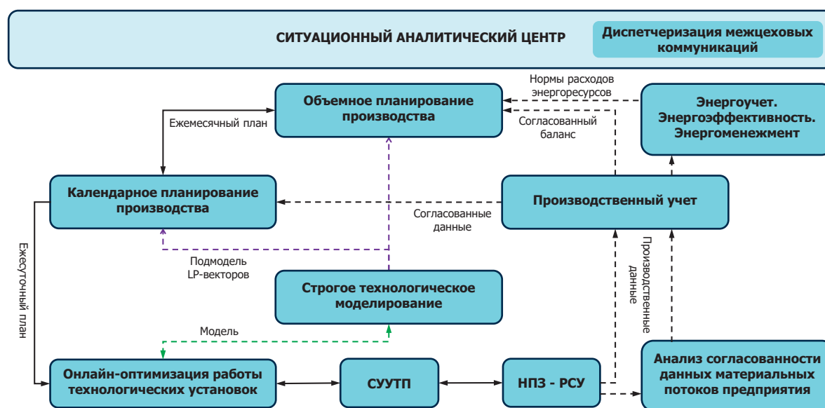
Рис. 5. Структура взаимосвязи программных продуктов в контуре цифровой экосистемы предприятия
