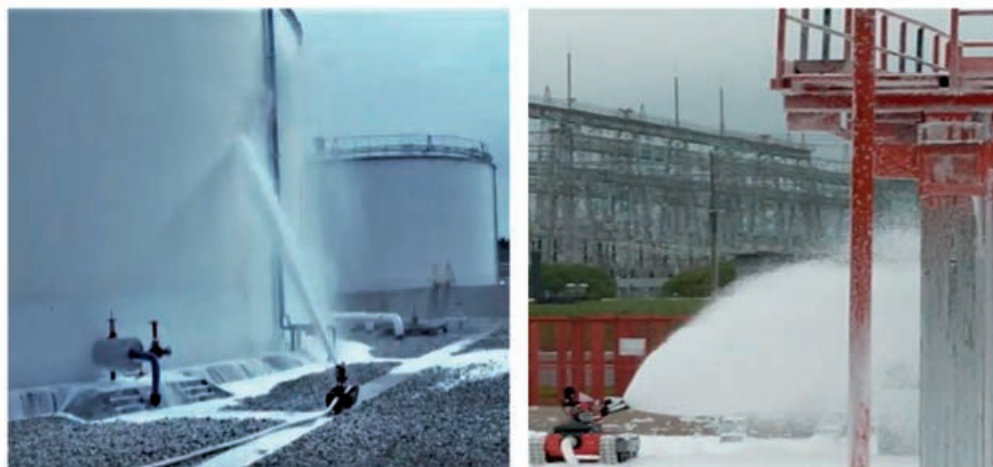
Рис. 8. Применение МРУП для подачи компактных и распыленных струй воды и компрессионной пены:
