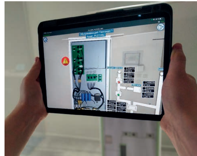
Применение дополненной реальности при обходах инженерами систем ИБП. Приложение показывает точное расположение внутренних компонентов и подсвечивает силовые линии, по которым в данный момент протекают токи и напряжение
