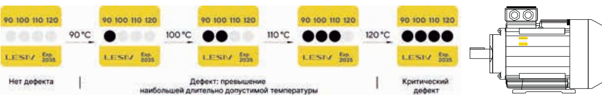
Рис. 5. Методология выявления дефектов обмоток статора электродвигателей (класс изоляции А) и точки монтажа термоиндикаторов на корпусе
