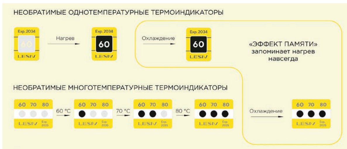
Рис. 3. Внешний вид и принцип работы термоиндикаторов
