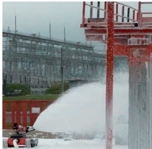
Рис. 8. Применение МРУП для подачи компактных и распыленных струй воды и компрессионной пены:
