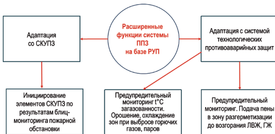
Рис. 5. Адаптация Комплекса ППЗ с системами противоаварийных защит и комплексного управления противопожарной защитой
