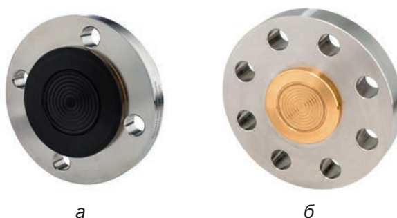
Рис. 4. Примеры защитного покрытия мембраны разделителя: а – фторполимерное; б – золотое
