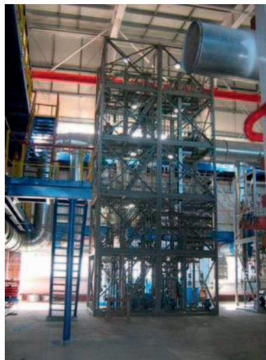
Фото 4. Универсальная установка ректификационного разделения широкого спектра физических свойств компонентов разделяемых многокомпонентных смесей, давлений и температур
