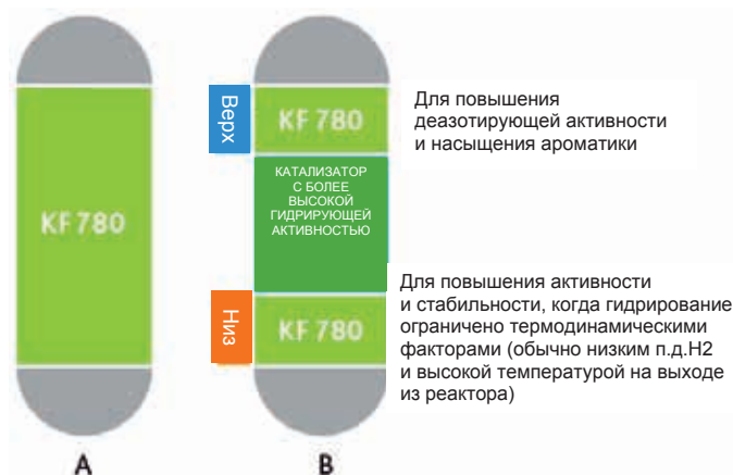
Рис. 1. Варианты типового применения KF 780 в реакторах гидроочистки средних дистиллятов при низком и среднем давлении: (А) в качестве отдельного самостоятельного решения и (В) в качестве компонента системы STAX в сочетании с катализатором, имеющим более высокие гидрирующие свойства
