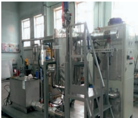
Фото 8. Установка для получения товарного терпинеола из соснового масла методом кристаллизации
