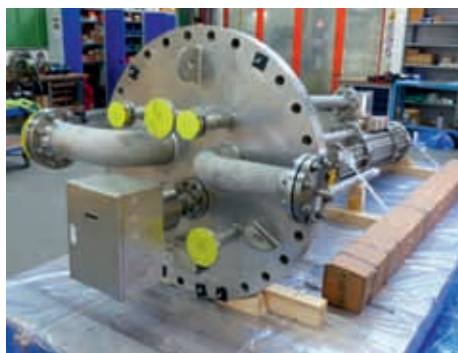
Насосы компании HERMETIC для перекачки сжиженного этилена ( -104^{\circ}\text{C} )
