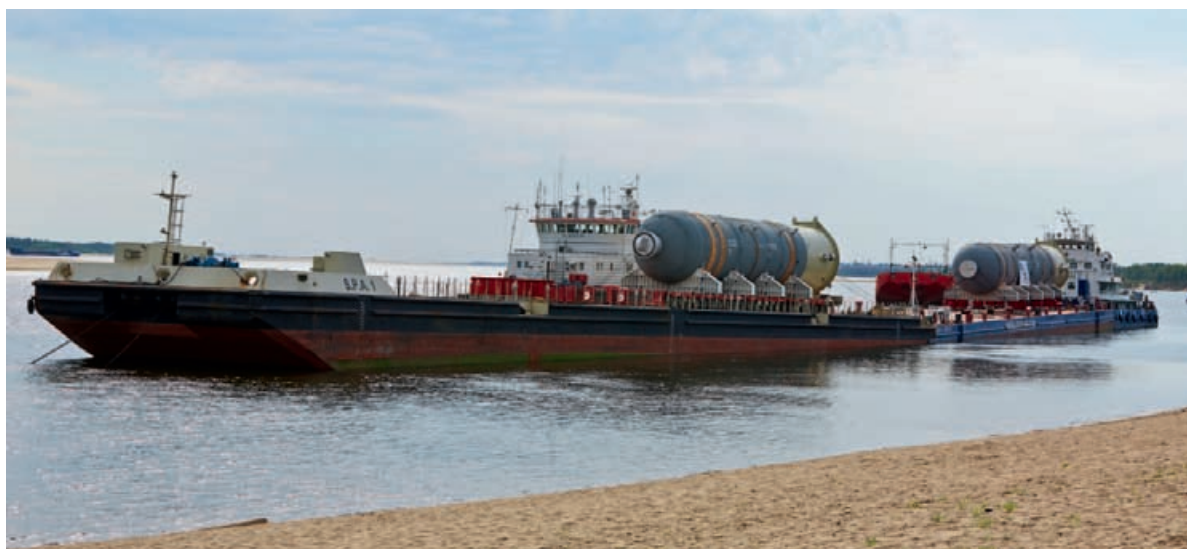
Рис. 10. Перекатка реактора массой 1116 т с одной баржи на другую, Волгоград, 2014 г.
