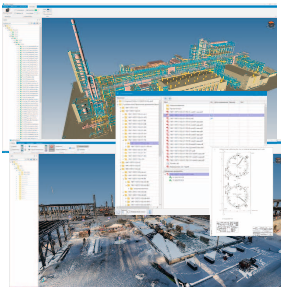
Цифровой двойник установки ЭЛОУ-АВТ-6, АО «ТАНЕКО», реализованный на базе ПК «3D Генплан»
