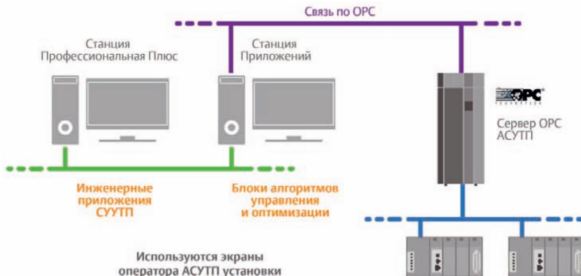
Рис. 2. Архитектура СУУТП на АСУТП другого производителя
