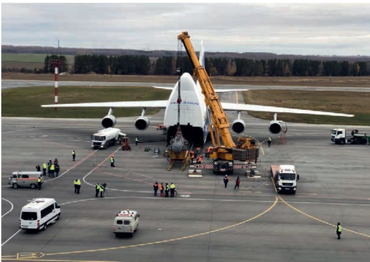
Выгрузка оборудования для компании ТАИФ в аэропорту Бегишево, г. Нижнекамск, кран LTM 1300/1
